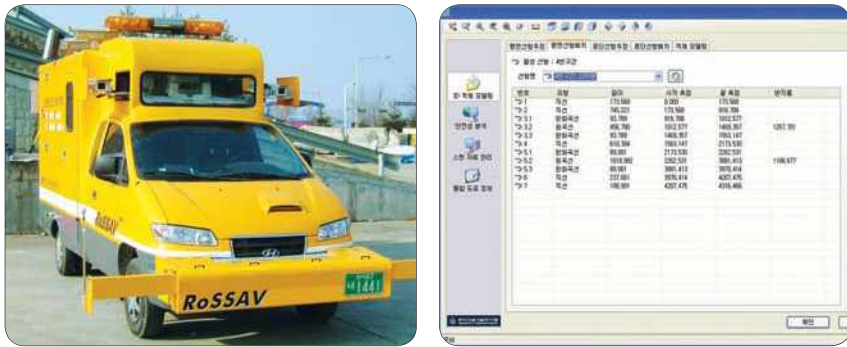
〈그림 1〉 도로안전성 조사 분석 차량(좌)과 선형 분석 결과(우)
